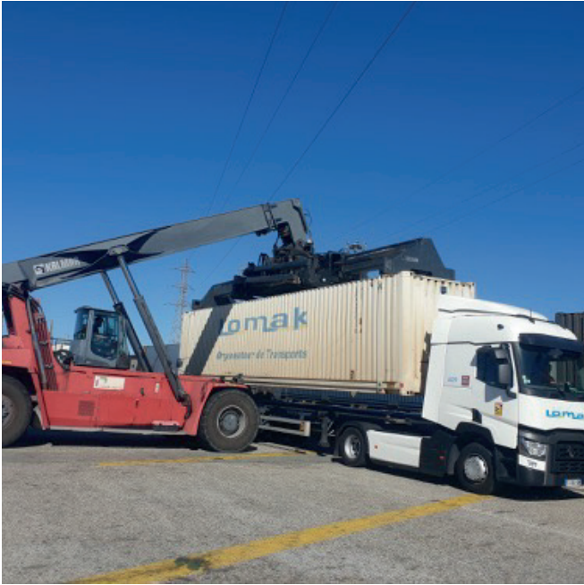
Figure 13 : transbordement d'une des caisses mobiles au terminal en Courtine
